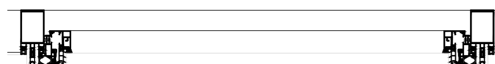
DRAAIKIEPRAAM IN VLIESGEVEL
